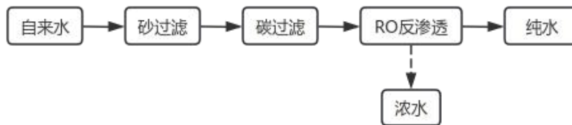
图 5 纯水制备工艺流程图
